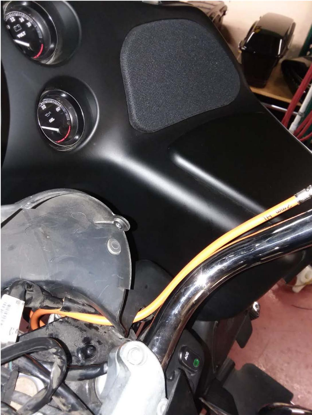
**FIGURE 12 LINE A ROUTING TO MASTER CYLINDER**
