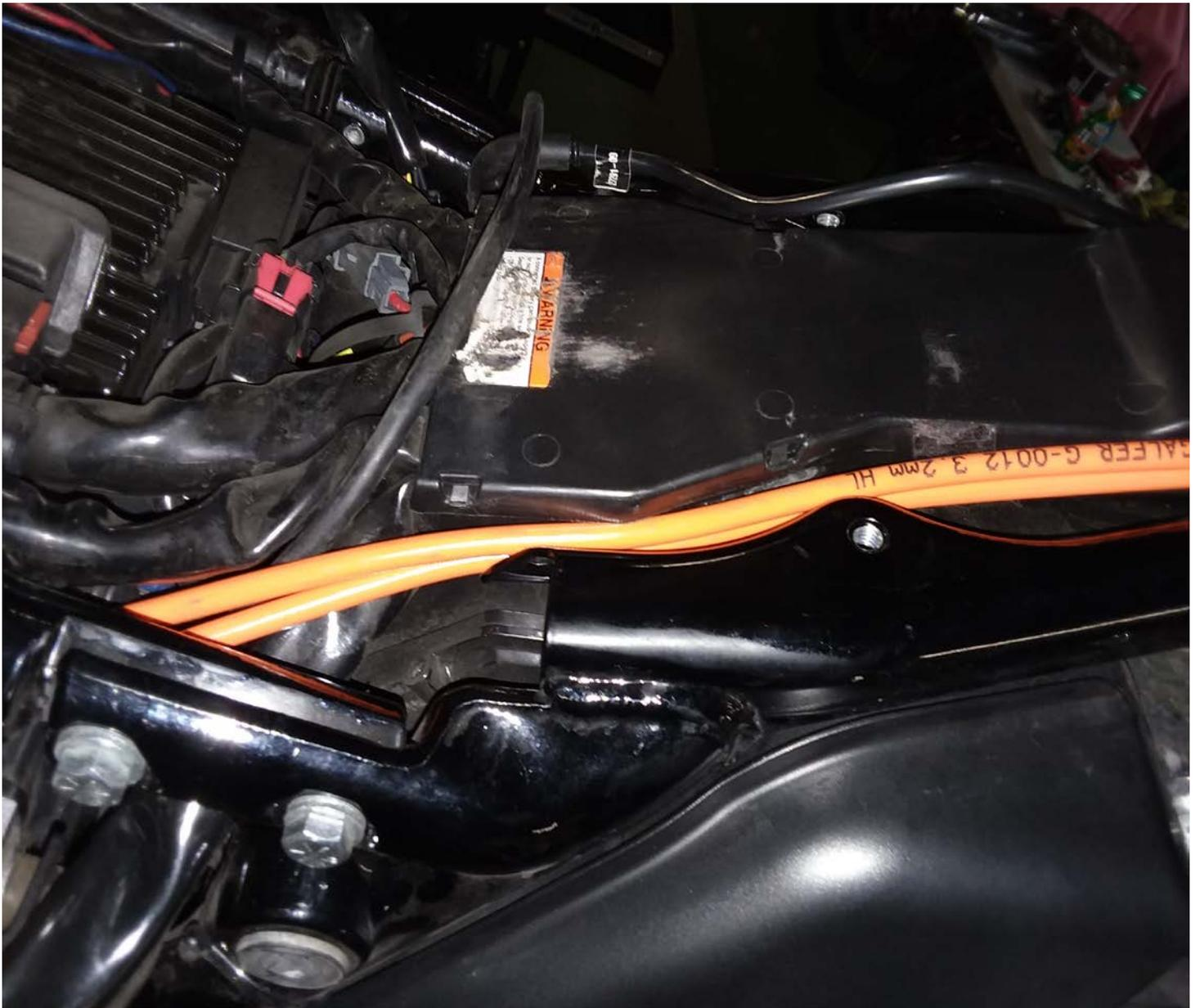
**FIGURE 10 LINE A/B ROUTING**
