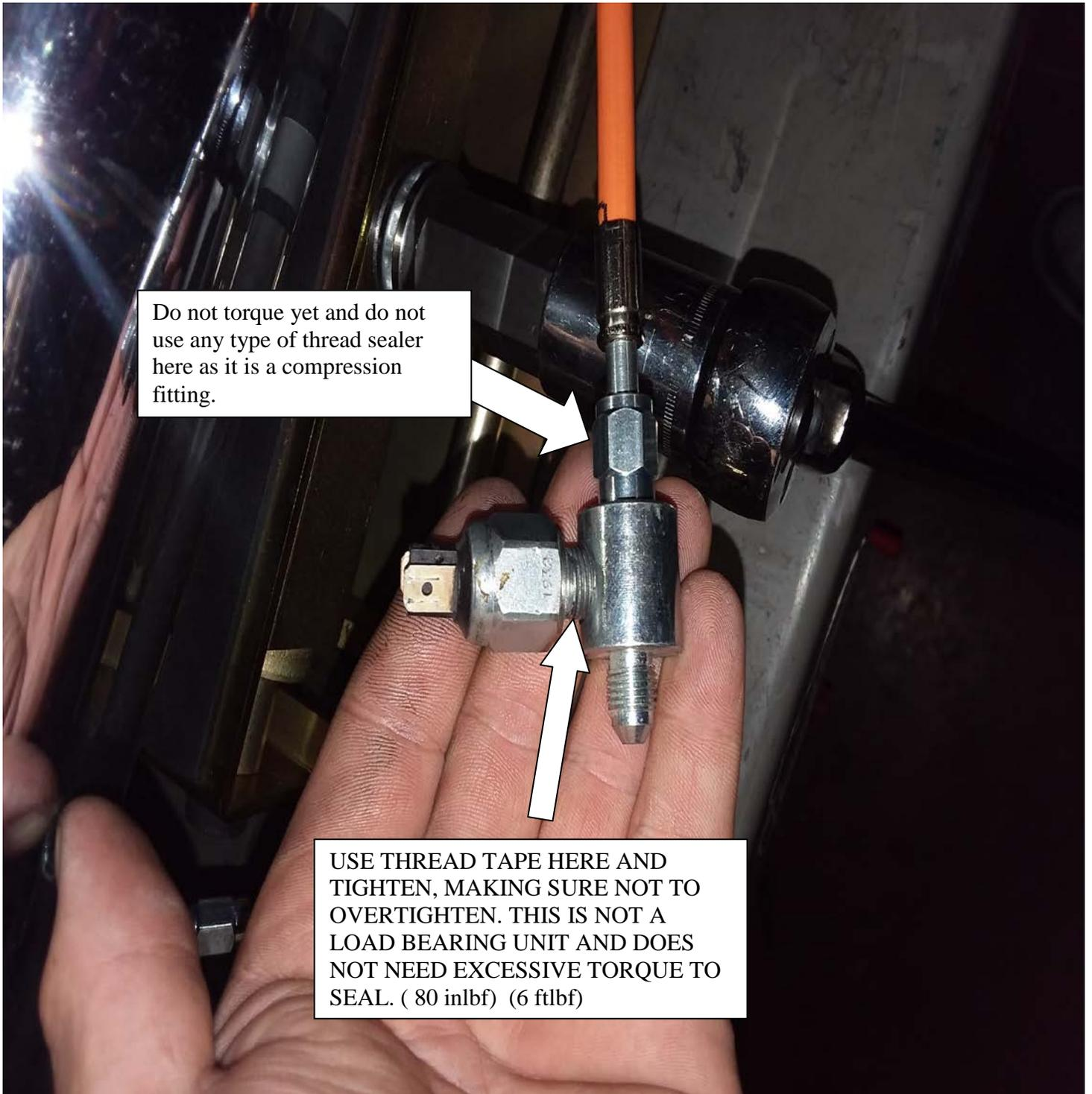
**FIGURE 17 BRAKE LIGHT SWITCH**
