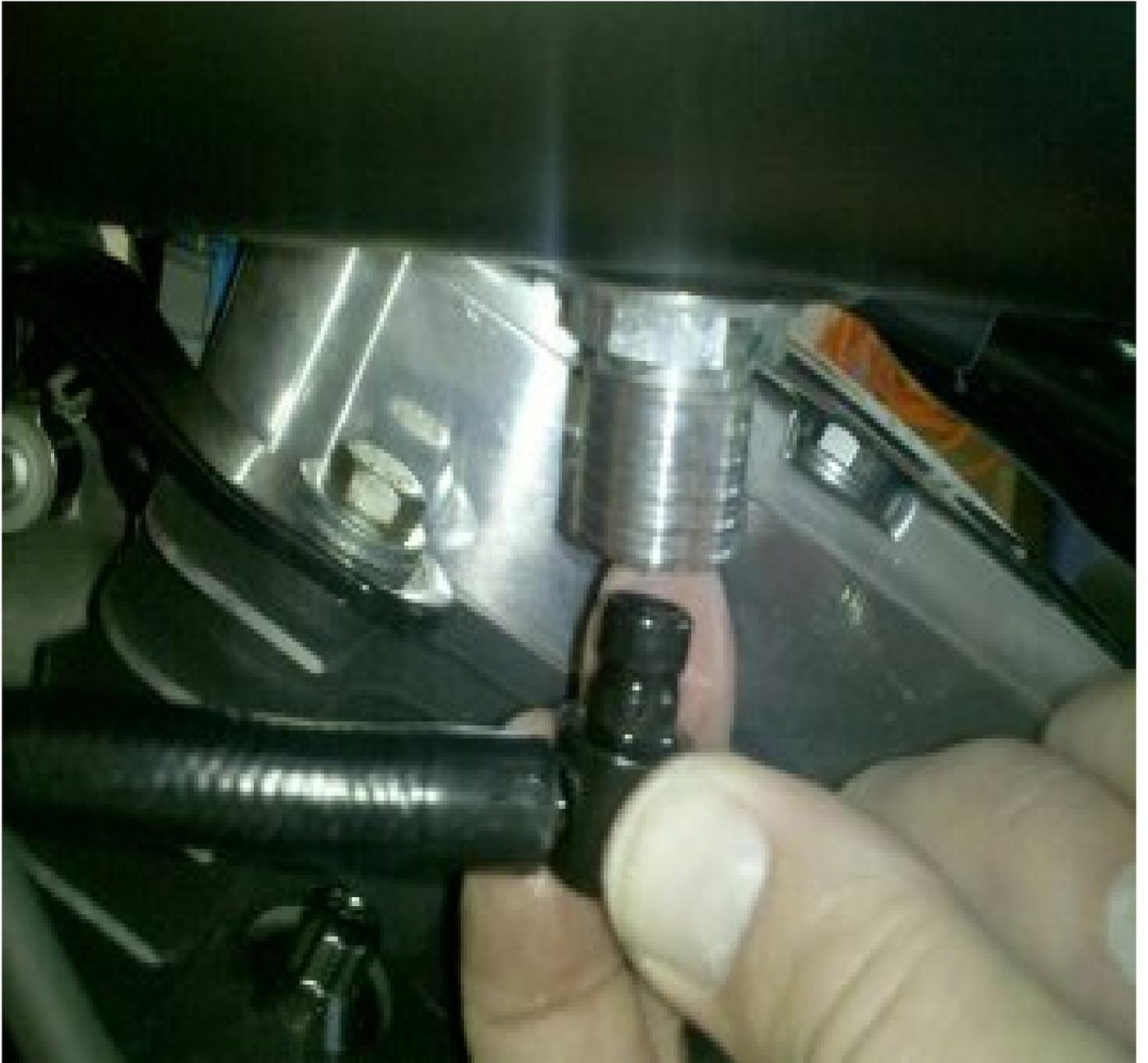
**FIGURE 2 FUEL LINE DISCONNECT**
