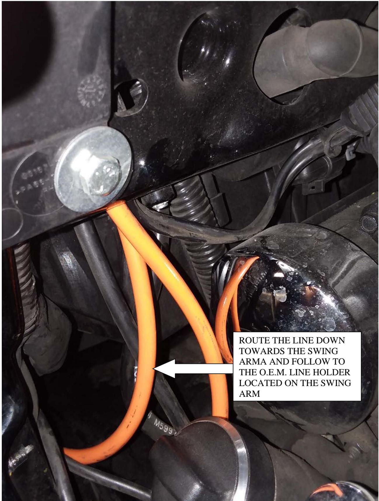
**FIGURE 20 LINE F ROUTING**
