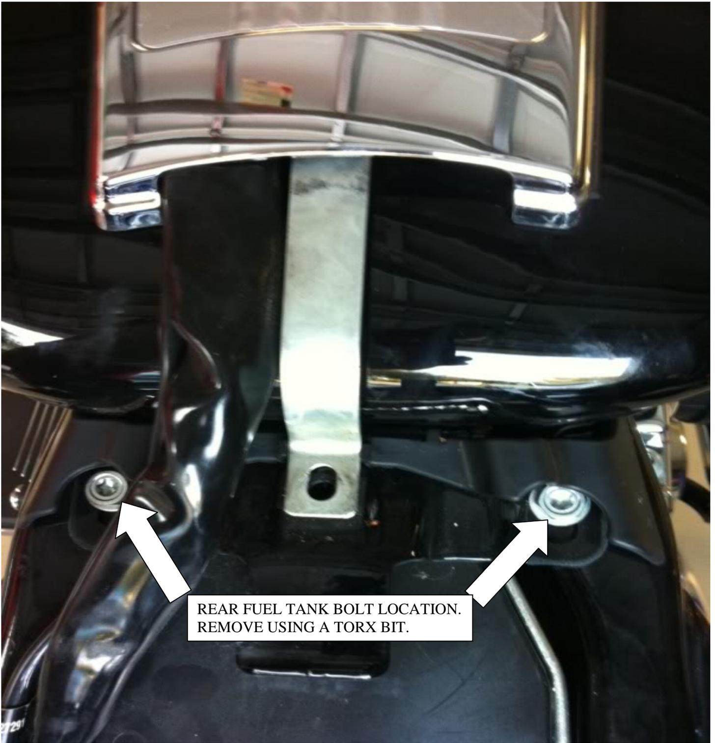
**FIGURE 4 REAR FUEL TANK BOLT LOCATION**
