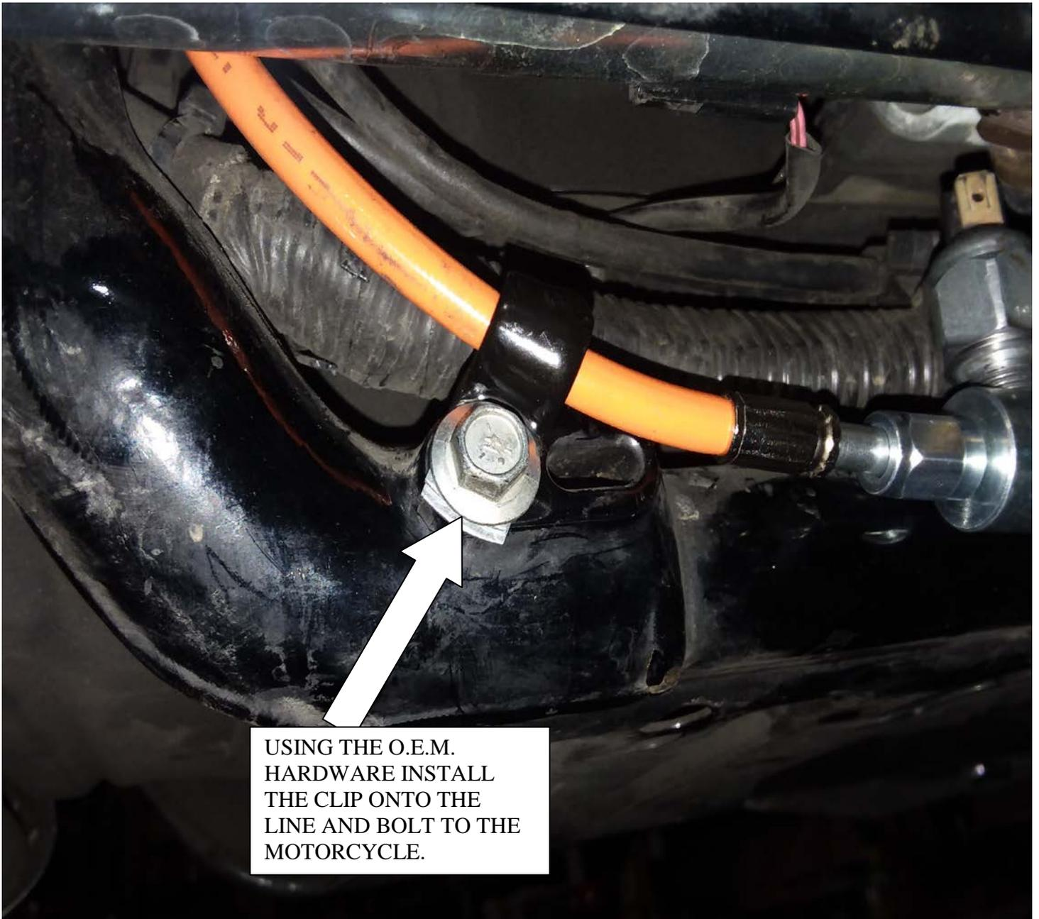
**FIGURE 18 LINE F INSTALLED**
